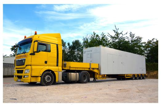
Typische Transportsituation: das MDC40 auf einem Tieflader. Aufgrund seiner Standardabmessungen sind keine besonderen Genehmigungen nötig.
